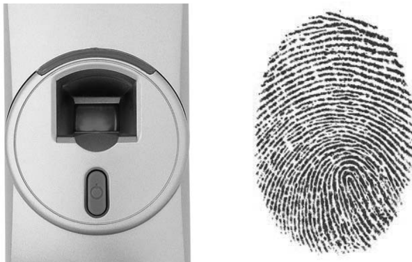
〈그림 II-1〉 광학식 지문 인식 기술을 이용한 도어 락과 지문의 모양
