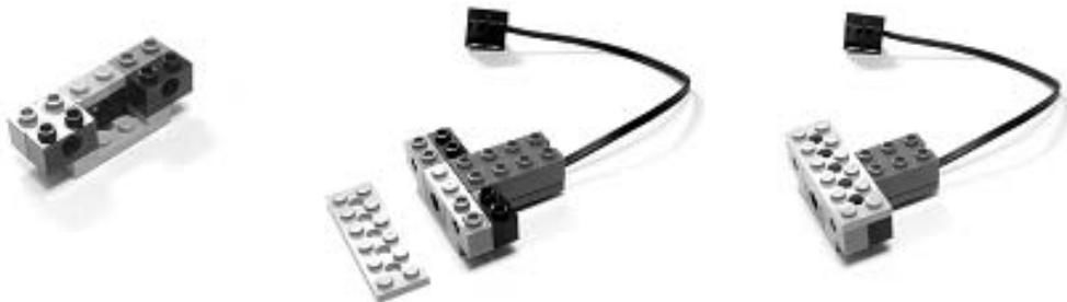
그림 5-30 빛센서 1개를 이용한 높이 조절형 빛 센서 모듈의 조립
