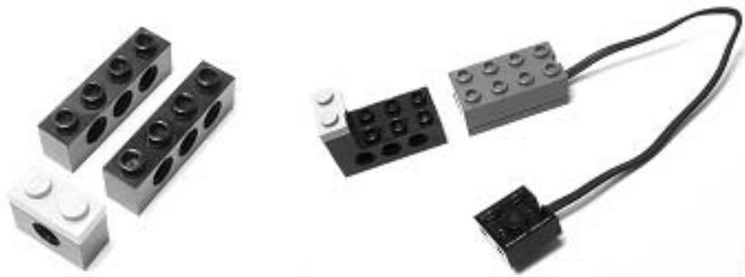
그림 5-26 베이스 부분 및 빛 센서의 조립
