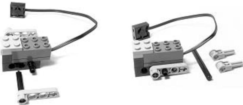
그림 5-28 센서 마운트를 조립하기 위한 부분
