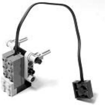
그림 5-29 고정형 빛 센서 모듈의 완성된 모습
