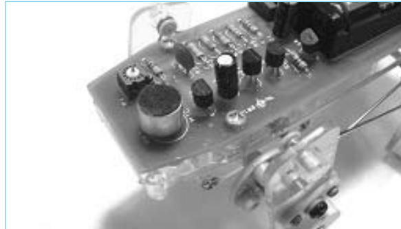
〈그림 2-29〉 기계식 로봇을 소리감지센서로 개조한 모습
